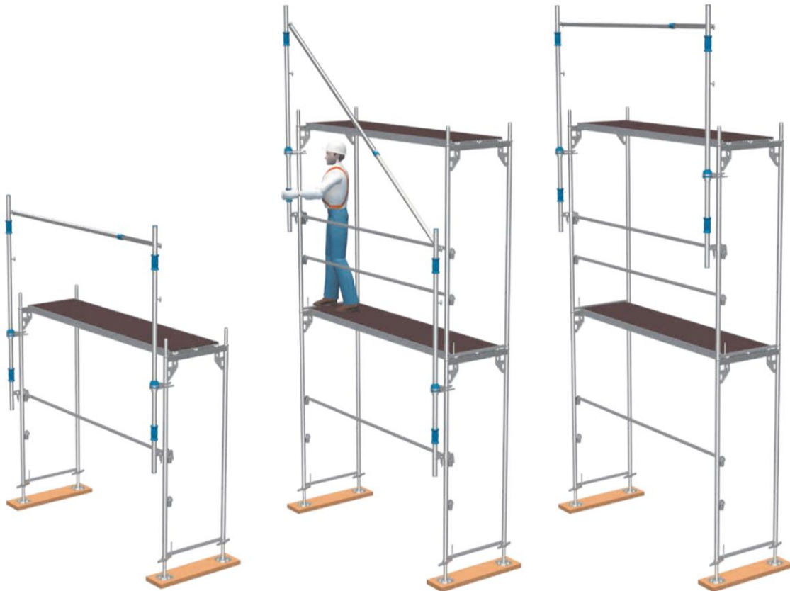
Bild 27: Blitz-Gerüstfeld mit MSG
